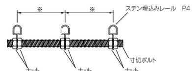
※1レールずつナットにて固定しながら希望のピッチに合わせる
